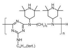
**特点:** 低挥发、耐迁移、耐高温、耐抽提、提升材料耐热性能
